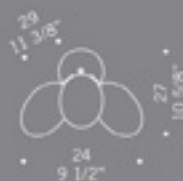
PRO•SECCO A3 3x20W-12V G4 alogena bispina halogen bi-pin trasformatore elettronico electronic transformer
