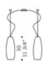
PERONI S14D2 CE 2x70W E27 alogeno chiara clear halogen 2x50W E27 - PAR 20 2x23W E27 fluorescente fluorescent cavo elettrico 200 cm cables length 200 cm
