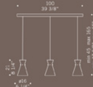
MEMORY S3PL 3x70W E27 alogeno chiara clear halogen 3x75W E27-PAR 30
