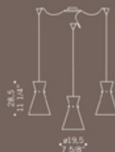
MEMORY S3GD 1x70W E27 alogeno chiara clear halogen 3x75W E27-PAR 30 3x20W E27 fluorescente fluorescent cavo elettrico 200 cm cables length 200 cm
