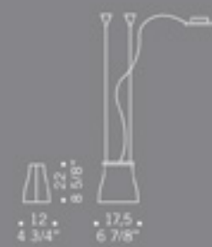
BELL S1D 1x70W E27 alogeno chiara clear halogen cavo elettrico 200 cm cables length 200 cm
