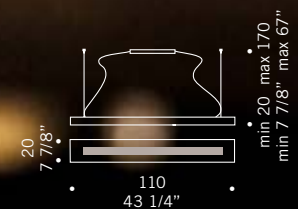
PLANA PLUS S110 2x39W G5 fluorescente lineare T5 alimentatore elettronico electronic ballast
