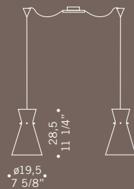
MEMORY S2GD 2x70W E27 alogeno chiara clear halogen 2x75W E27-PAR 30 2x20W E27 fluorescente fluorescent cavo elettrico 200 cm cables lenght 200 cm
