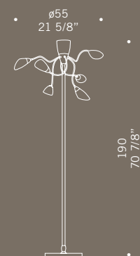
POLI PÒ R 6x40W E14+ sferetta chiara little sphere 1x150W E27 alogeno chiara clear halogen con variatore with dimmer
