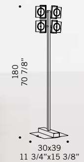
SAN SIRO R4 4x75W G53 halospot 111 trasformatore magnetico magnetic transformer
