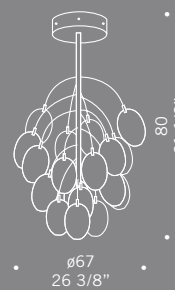
PRO•SECCO K19 19x20W-12V G4 alogeno bispina halogen bi-pin trasformatore magnetico magnetic transformer
